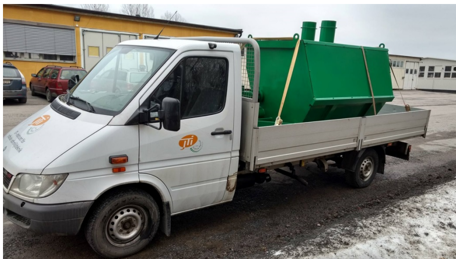
Figur 2: Uppsamlingscontainern för bottenaska redo för transport. De två rören på taket samlade upp aska som sedan kunde tömmas från sidan via en skruv.
